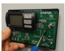
D. Retire la placa posterior del controlador y marque los puntos de montaje en el lugar deseado.
