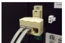
G. Branchez le câble à l'arrière de la commande à distance de l'interface utilisateur et fixez la plaque de fixation à l'aide des deux vis fournies avec la commande à distance de l'interface utilisateur.
