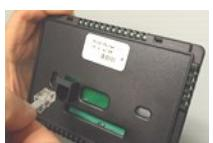
C. Coloque la interfaz de usuario remoto en un punto medio sobre alguna pared dentro de la bodega en un área con buena circulación de aire y lejos de las ventanas o fuentes de calor.
