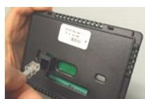
C. Posizionare l'interfaccia utente a distanza all'interno della cantina, al centro di una parete, in una zona ben ventilata e lontana da finestre o fonti di calore.
