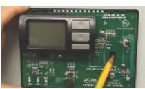
B. Koppel de kabel los van de zijkant van de Wine Guardian en de bedieningseenheid. Leid de kabel naar de gewenste montagelocatie in de wijnkelder.
