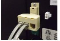
F. Maak een gat van 32 mm diameter in de muur of het rek om ruimte te maken voor de RJ14 aansluiting achterop het paneel.
