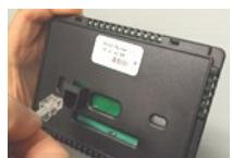
**C.** Befestigen Sie die Remote-Bedienoberfläche in der Mitte des Kellers an einer Wand mit guter Luftströmung und weg von Fenstern oder Wärmequellen.
