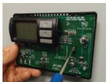
E. Haga dos agujeros de 1/8" (3 mm) e introduzca los soportes en la superficie de montaje. Puede que no necesite los soportes si sujetela sistema mediante montantes a la pared o estanterías.
