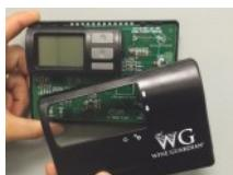
A. La unidad se suministra con 50 pies (15 metros) de cable, cable con conexión de tipo RJ14 para el controlador de interfaz de usuario remoto.
