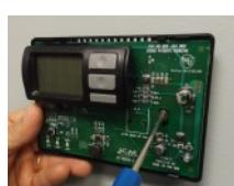
**D.** Entfernen Sie die Rückseite der Bedienung und markieren Sie die Befestigungsstellen an der gewünschten Stelle.
