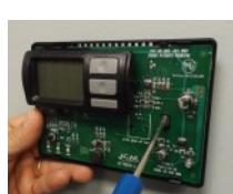
D. Rimuovere la piastra posteriore del comando e segnare i punti di montaggio nella posizione desiderata.
