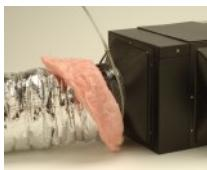
B. Instale el conducto plegando el aislamiento para exponer el conducto de vinilo reforzado con alambre. Deslice el conducto sobre el extremo del cuello del conducto y sujetelo usando las dos abrazaderas suministradas con el conjunto, asegurándose de que el conducto está apretado sobre el cuello.
