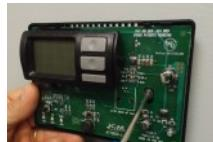
E. Percez deux trous de 3 mm puis insérez les fixations dans l'emplacement de montage. Les fixations peuvent s'avérer non nécessaires dans le cas où la commande à distance est fixée à des poteaux muraux ou à une étagère.
