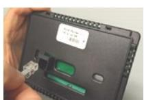
C. Plaats de bedieningseenheid midden in de wijnkelder op een muur in een deel met een goede luchtstroom en uit de buurt van ramen en hittebronnen.
